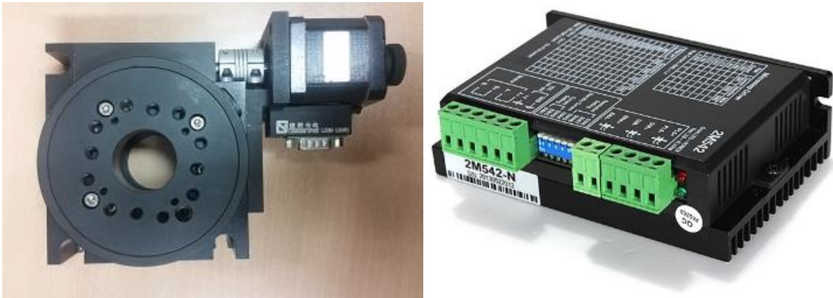
Abbildung 7: Präzisionsdrehtisch mit Schrittmotor und zugehörigem Schrittmortreiber
